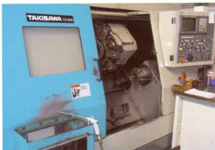
Auf dieser Maschine bei Ostlangenberg werden die Naben gedreht.
